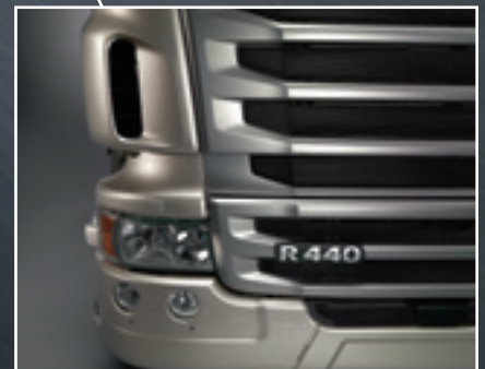
Grillen har betydligt större öppningar mellan de tydliga horisontella ribborna. Detta understryker Scanias identitet och släpper samtidigt in mer luft till kylaren och motorrummet.
