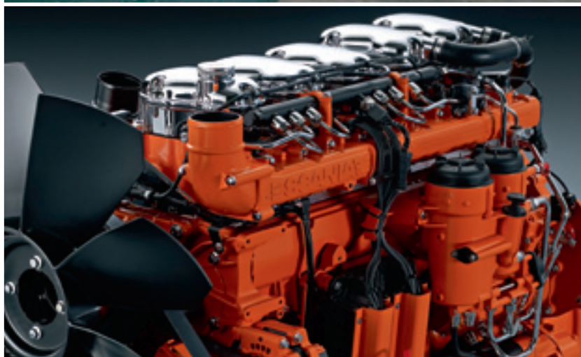
En Scania 9-litersmotor för industriellt bruk.
